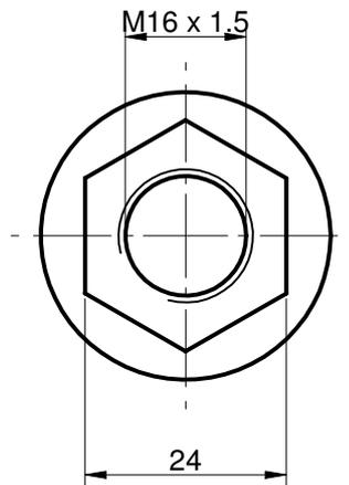
Norma de construção: DIN 6927
