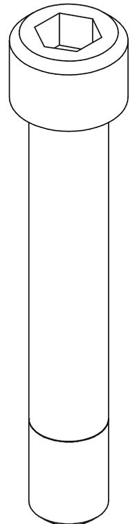
**Nota:** Parafuso com comprimento do corpo e comprimento da rosca em medidas especiais, sendo o restante das medidas conforme norma especifica para parafuso polegada.
